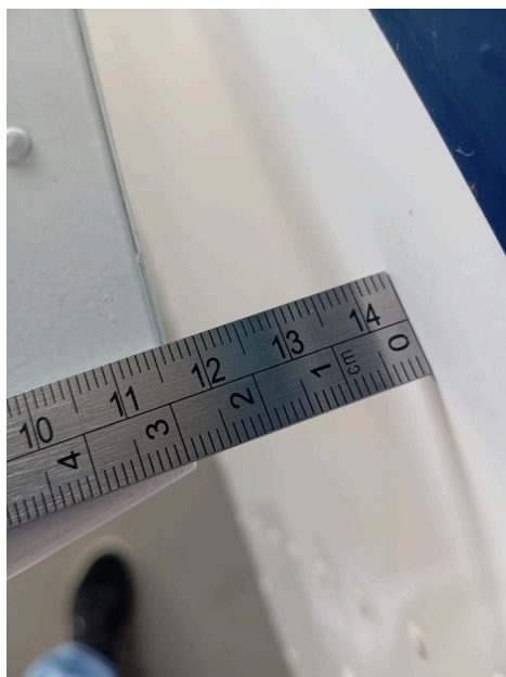
Figura 3.6.3.6. Espaço medido em deflexão máxima do leme.
