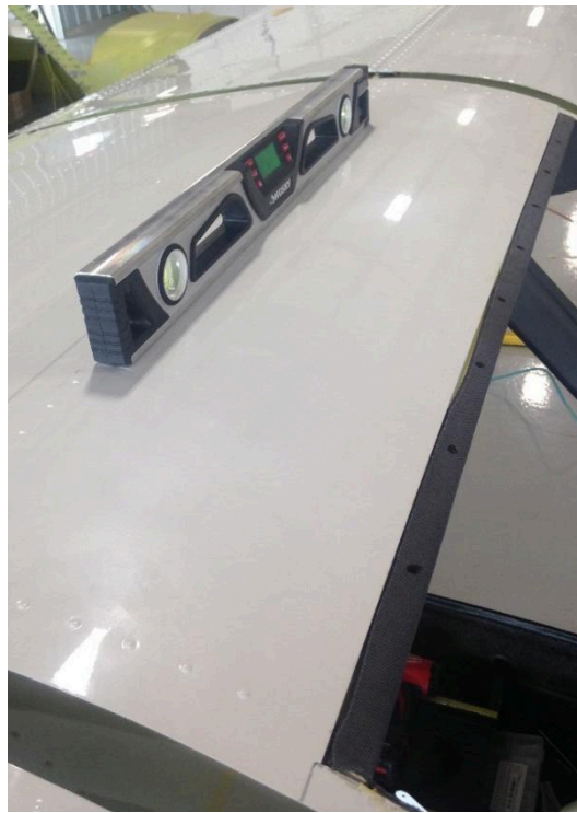
Figura 2.1.2. Alinhamento da fuselagem.
