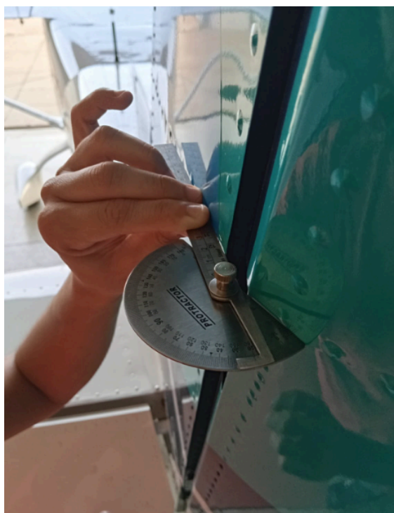
Figure 3.6.3.4. Medida na linha de rebites
