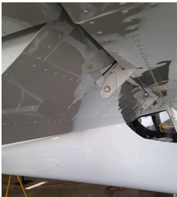
Figura 1.10.2.5.1. Fixações dos Flapes.
