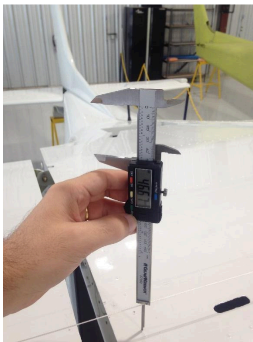
Figura 2.1.4. Altura da linha na fuselagem.
