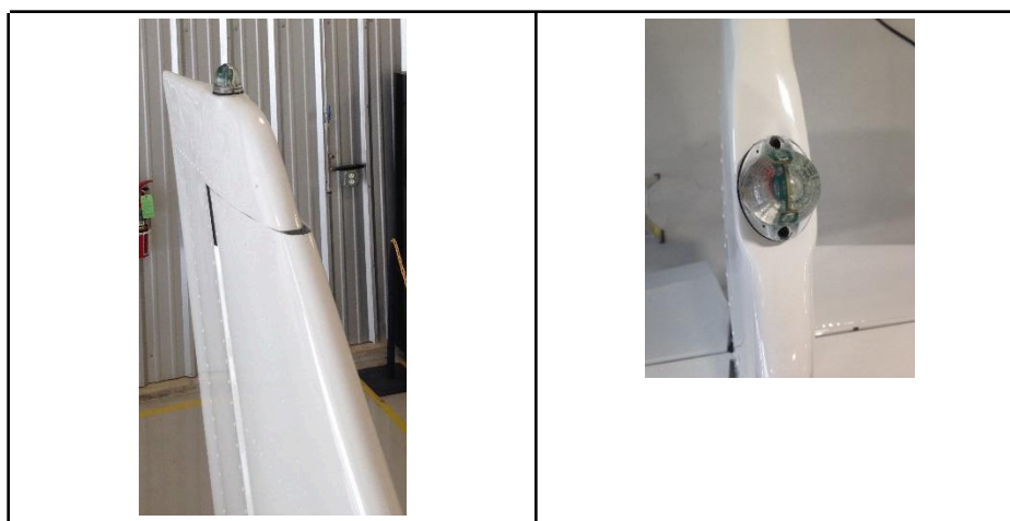
Figura 2.4.15.2. Beacon Light no estabilizador vertical.
