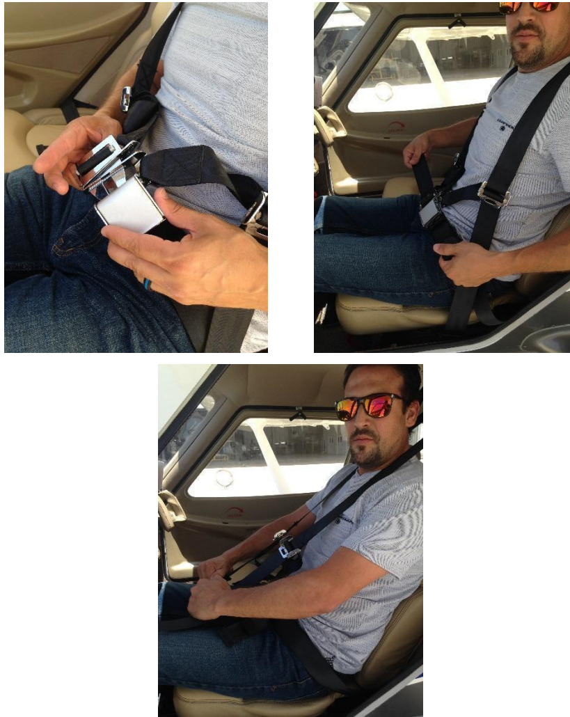
Figura 1.2.2. Ajuste do cinto de segurança.
