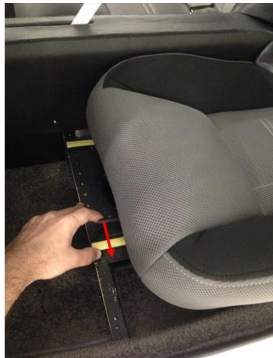
Figura 1.2.1. Ajuste do assento.
