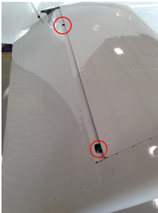
Figura 1.10.2.2.2. Pontos de fixação do profundor.
