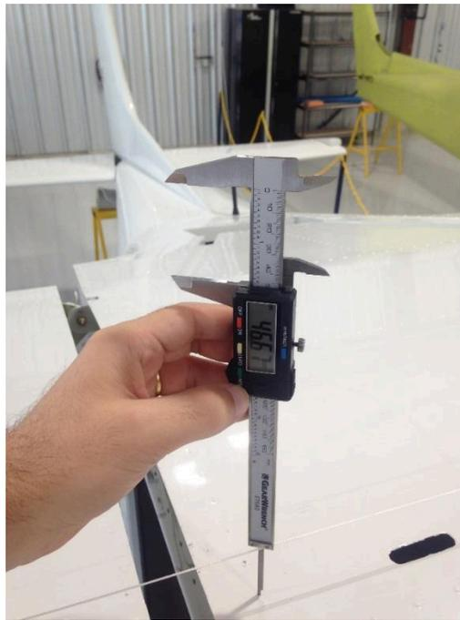
Figura 2.1.4. Altura da linha na fuselagem.
