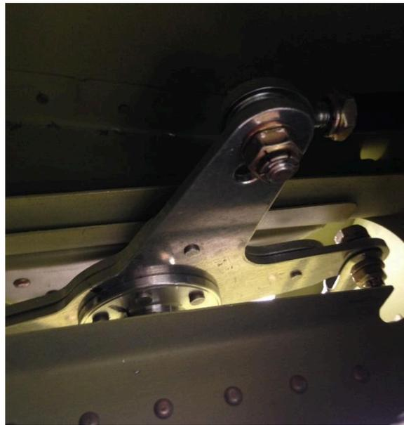
Figura 1.10.2.3.1. Horn de Aileron.
